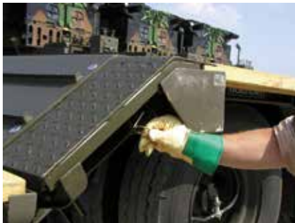
Figur 14 - Sichern der Stahlverbreiterung
