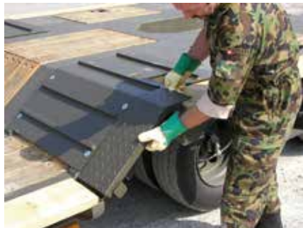
Figur 13 - Einsetzen der Stahlverbreiterung
