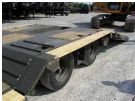
Figur 15 - Verbreiterung der hinteren Plattform
