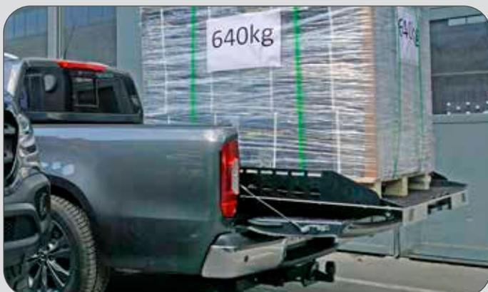
Der Ladeboden kann mit der maximalen Beladung von 600kg spielend ausgezogen werden. Auszugslänge 1000mm.
