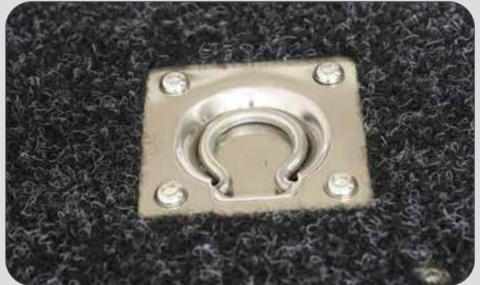
Der Top Auszug verfügt über 9 kräftige Zurrösen aus Edelstahl. Für mehr Stabilität sind die Ösen im Metallrahmen und nicht an der Holzplatte verschraubt.
