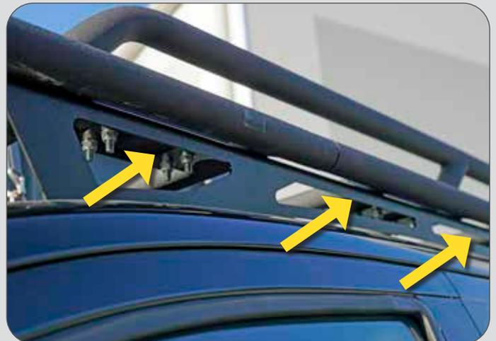
Integrierte Zurrpunkte im Dachträger Fuß
