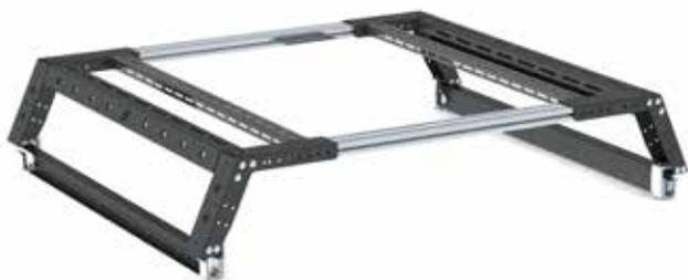
Der LowTop wird gerne verwendet, um darauf ein Dachzelt zu montieren, da es durch die geringe Aufbauhöhe dann nicht über die Dachkante raussteht.
