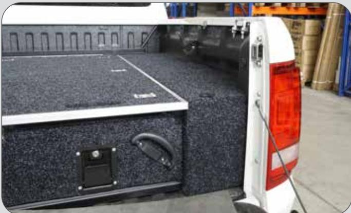
Die Griffschalen sind verschließbar und verfügen noch zusätzlich über Griffe für eine komfortable Bedienung. Wir bieten zusätzlich seitliche Verkleidungen an, um wieder einen geraden Ladeboden herzustellen.
