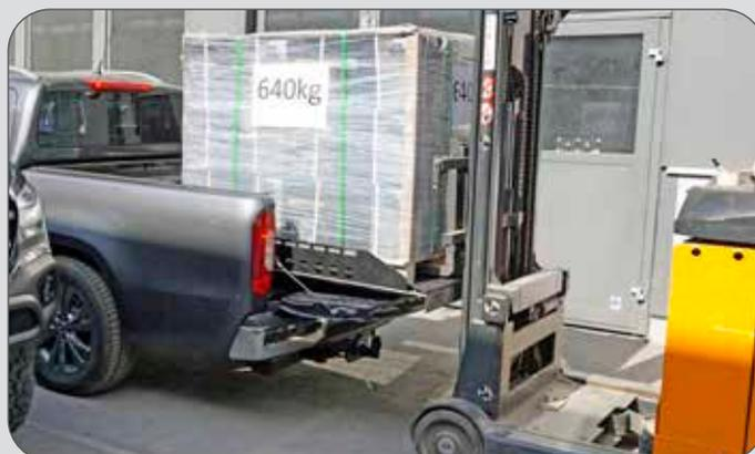
Das System ist für die Beladung mit dem Stapler ausgelegt. Da die volle Kapazität im ausgezogenen Zustand beladen werden darf, wird die Ladeklappe geschützt.
