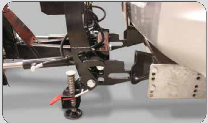
Das Quick-Montagesystem erleichtert das Andocken auch bei schlechter Sicht. Die Elektrik wird über nur einen wasserdichten Zentralstecker verbunden.
