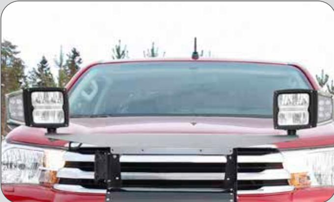
Ein zugelassener moderner LED Scheinwerfer hilft dir, dich auch im dichtesten Schneegestöber zurecht zu finden. Die Lampen verfügen über eine eigene Linsen-Heizung, damit sie nicht vereisen. Die Blinker, sowie das Auf und Abblendlicht sind ebenfalls inkludiert in dem hochwertigen Scheinwerfer.
