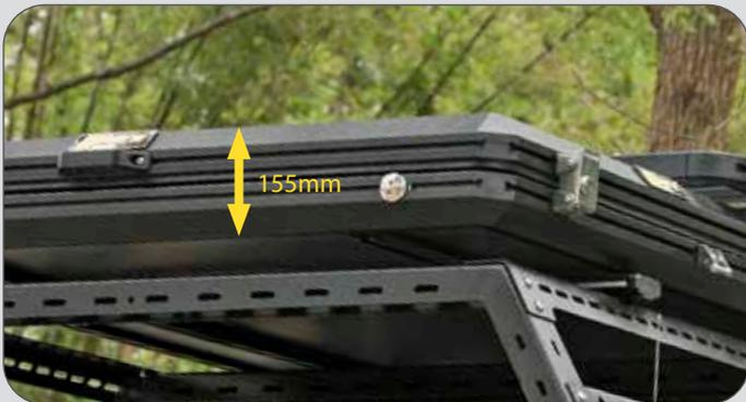
Durch die Super Slim Bauweise ist die komplette Bauhöhe nur 155mm in geschlossenem Zustand. Ein Wert, der einzigartig ist in diesem Segment. Die 2,5mm dicke Honigwabenhaut Aluminium Außenhaut ist mit Alu Profilen verstärkt.
