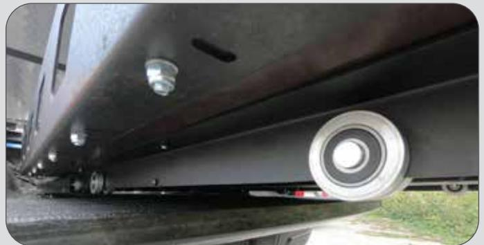
Der Rahmen läuft komplett auf 22 Kugellagern, die bei Bedarf sehr leicht gewechselt werden können.
