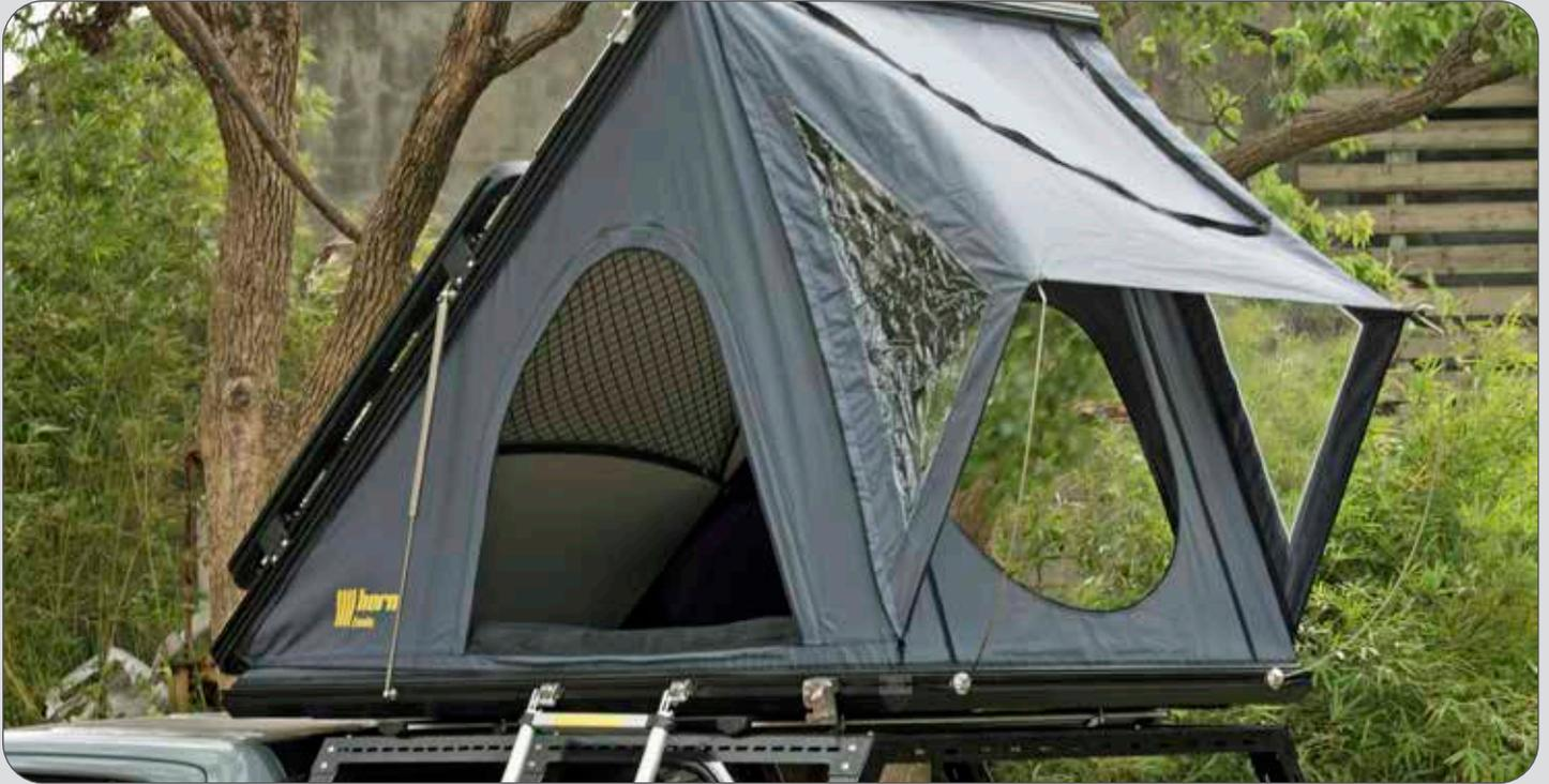
Drei Eingänge/Fenster, bei Bedarf Wind und Wetter geschützt. Alle mit einem Moskitonetz versehen. Auf allen drei Seiten mit der mitgelieferten Leiter zu erreichen. Der Edelstahl-Dämpfer ist außen angebracht, somit stört er nicht im Innenraum.
