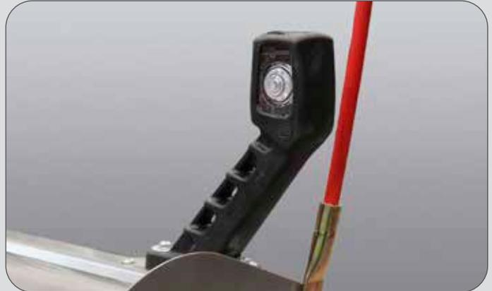
Die LED Positionsleuchten erhöhen die Sicherheit und die Sichtbarkeit der Scharräder.
