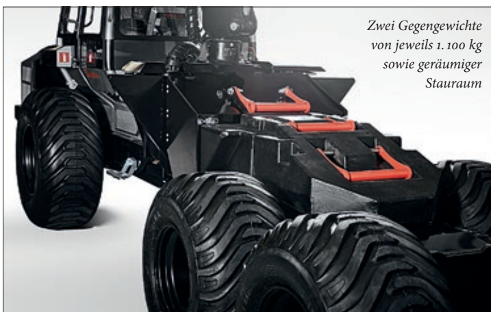
Die Umstellung vom Harvester auf den Forwarder dauert etwa 20 Minuten.
