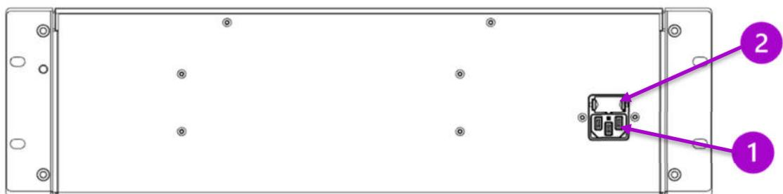
1. Netzanschluss – 220 bis 240V Wechselspannung
