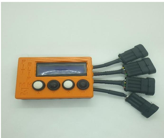
Wenn das System so verkabelt und an eine Spannungsquelle angeschlossen ist sollte das Display blau leuchten und die ersten Einträge im Einstellungs Menü angezeigt werden.
