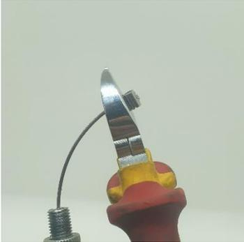
4. Trennt die Gaszughülle an der vorher gemachten Markierung ab. Soll die Gaszuglänge gleichbleiben, kürzt den gasgriffseitigen Teil der Hülle um 61mm. Um eine Deformation durch den Seitenschneider zu vermeiden eignet sich hierfür am besten ein Dremel oder Winkelschleifer
