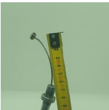
3. Trennt den oberen Nippel mittels Seitenschneider ab damit ihr das Seil selbst aus der Gaszughülle herausziehen könnt.
