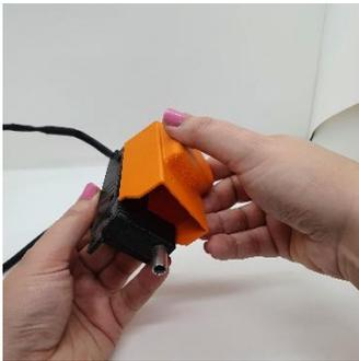
Anschließend mit einem flachen Metallstück(zur Not geht auch eine Gabel) zwischen Servo und Deckel einhaken und.....
