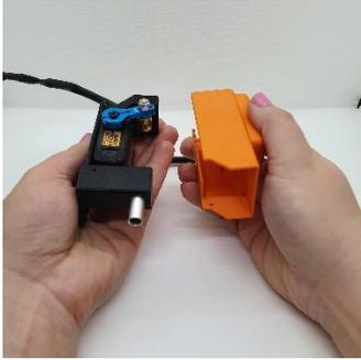
Dreht den Deckel von rechts nach links über den Servo.
