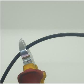
5. Schiebt die Metallhülse auf die vergaserseitige Gaszughüllen auf und verpresst diese leicht mit dem Seitenschneider. Die Metallhülse nur auf der Vergaserseite anbringen.
