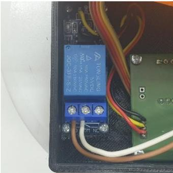
Die Beiden Kabel einfach von den linken Anschlüssen auf die rechten Anschlüsse montieren.
