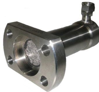
Abbildung 1: Regeneratorgehäuse mit Matrix einer Versuchsmaschine am Lehrstuhl für Thermodynamik
