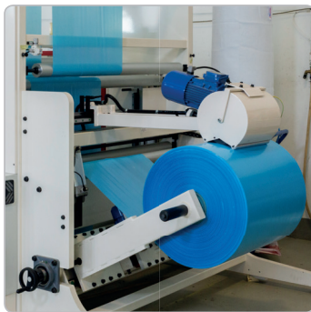
Surface unwinding unit type "shaft-less" with vertical dancing roller Svolgitore periferico shaft less con bandiera verticale
