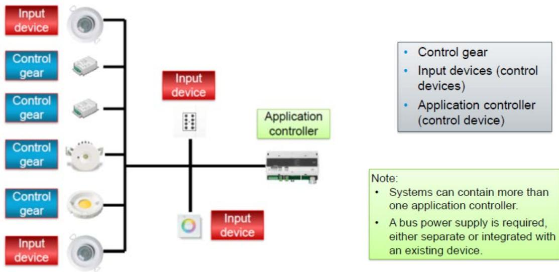
Figure 5 : Architecture d'un système DALI-2 (Source DiiA)
