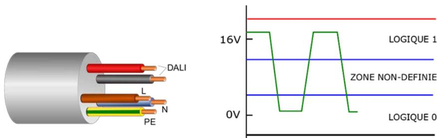
Figure 1 : Câblage typique et fluctuations en tension
