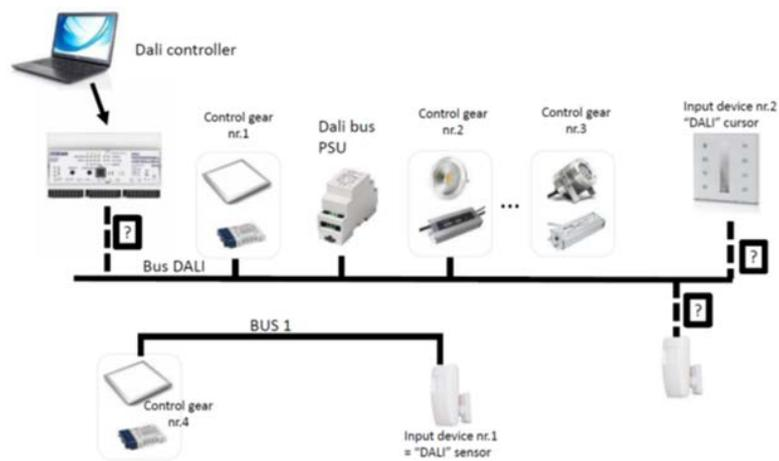
Figure 4 : Réseau avec deux bus DALI
