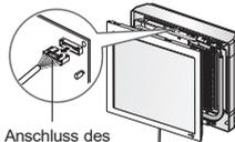
Anschluss des Plattenvorderteils
