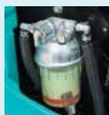
Kraftstoffvorfilter mit eingebautem Wasserabscheider
