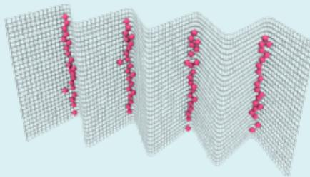
• 30er-Maschen bedeutet, dass durch horizontale und vertikale Drähte 30 Öffnungen pro Quadrat-Zoll (6,45 Quadratzentimeter) gebildet werden.
