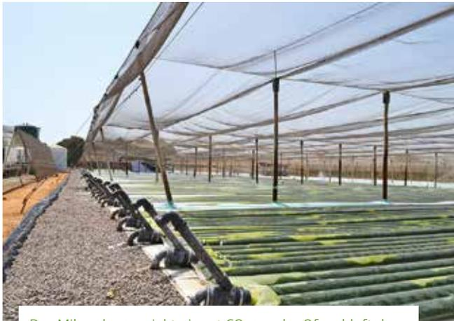
Das Mikroalgenprojekt nimmt CO<sub>2</sub> aus der Ofenabluft des Zementwerks auf. Die Algen, die als Fischfutter dienen, werden in kostengünstigen Bioreaktoren gezüchtet.
