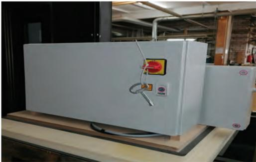
Der Strom sollte von einem Elektrofachmann angeschlossen werden. Auf dem Gerät sitzt der Hauptschaltkasten, der über eine Elektroeinheit mit einem roten Hauptschalter verfügt. Schalten Sie das Gerät damit ein und aus. Um an den Hauptschalter zu kommen, muss man das Revisionsblech abschrauben.
