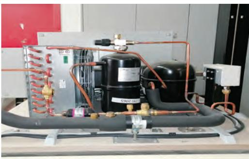
Die Kältetechnik wird gefüllt mit Kältemittel R-513a geliefert und befindet sich ebenfalls oben auf der Zelle.
