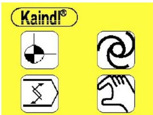
Durch drücken der Programmeingabe-Taste gelangen Sie in das Menü, wo Sie die entsprechenden Zustellwerte eingeben wie z. B. Zustellmaß, Zustellung, Pausenschritte und die Ausfunkschritte.
