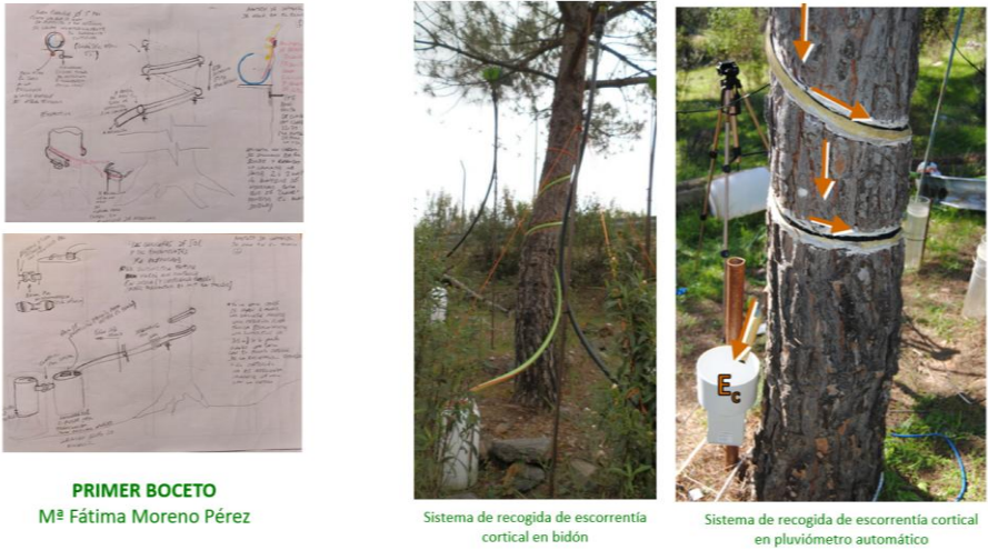
Figura 11. Boceto y estructura final construida para la recogida de la escorrentía cortical en Pinus pinea (Moreno-Pérez et al., 2013)
