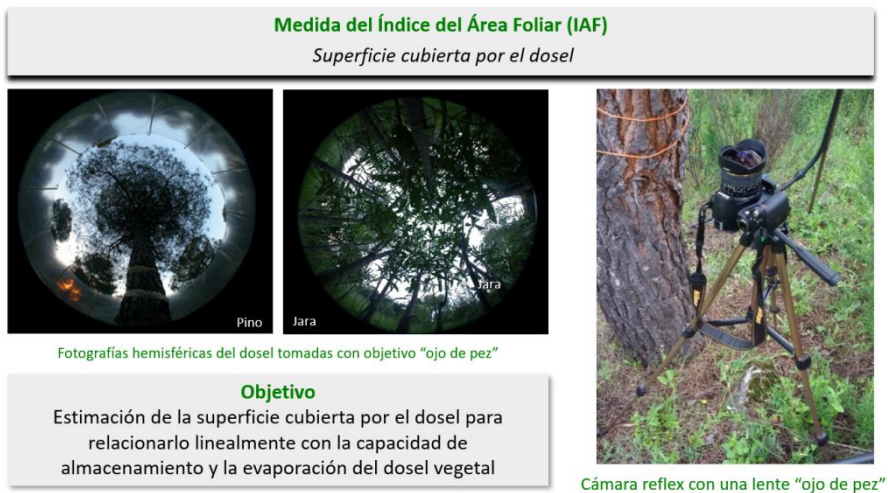
Figura 15. Fotografías hemisféricas realizadas con una cámara fotográfica equipada con una lente «ojo de pez»
