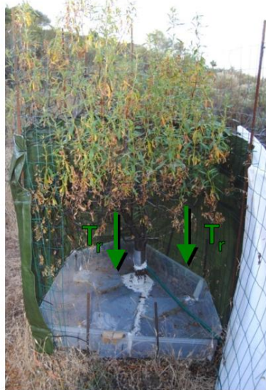
Figura 6. Boceto y estructura final construida para la recogida de la trascolación en Cistus ladanifer
