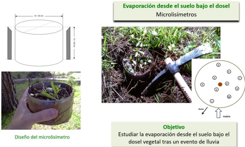
Figura 14. Uso de microlisímetros para la medida de la evaporación desde el suelo, bajo y fuera de la influencia del dosel vegetal
