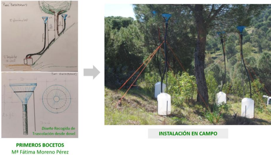
Figura 8. Boceto y estructura final construida usando colectores en forma de embudo para la recogida de la trascolación en Pinus pinea
