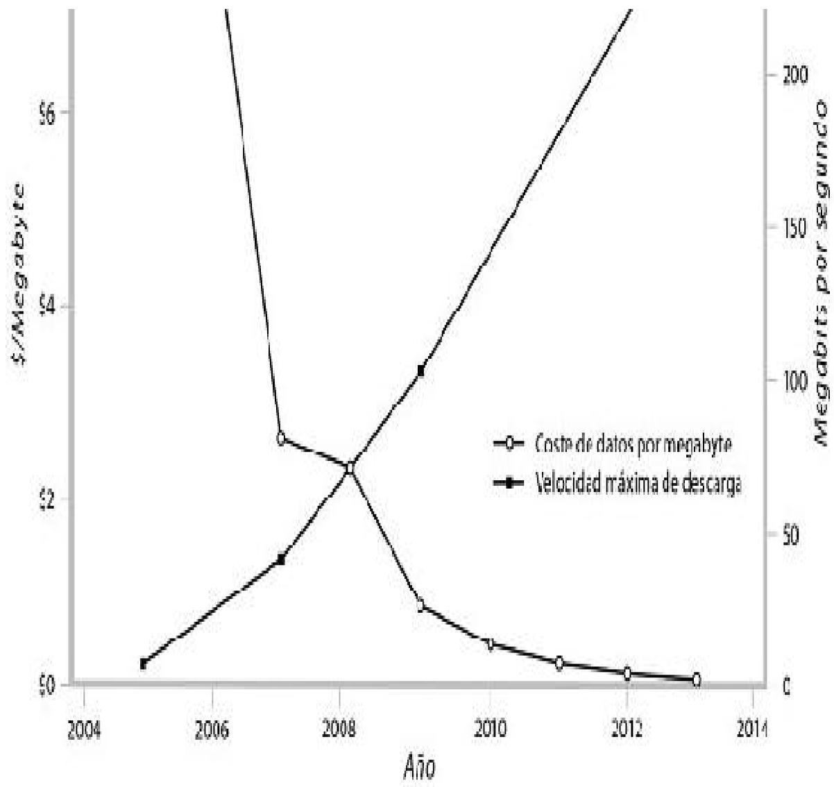
Nota: La velocidad de datos indica la velocidad de enlace descendente máxima, no el promedio observado. La velocidad promedio observada depende de muchos factores, incluida la infraestructura, densidad de usuarios, y el hardware y software del dispositivo.
