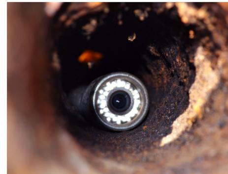
und dient u. a. bei Nachfrage durch die zuständigen Behörden (Bsp.: untere Wasserbehörde) zum Nachweis im Rahmen der Überwachungspflicht des Hauseigentümers als Betreiber einer abwassertechnischen Anlage gemäß DIN 1986 - Teil 30!
