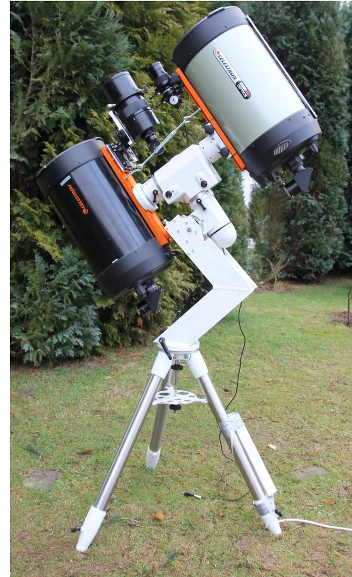
Die Knicksäule mit zwei C11 Teleskopen und einem Leitrohr. Oben das Spannschloss zur Ausrichtung der Teleskope. Mitte links ist die Polhöhenwiege zu sehen. Unten links die Schrauben zur horizontalen Ausrichtung auf der Säule.
