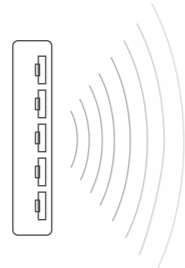
Punktquelle kugelförmige Abstrahlung, hohe Lautstärkeabnahme
