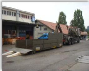
Für den Verlad und den Transport des Gasta Linde 2,5t 4x2 H30d wird ein Transportbehälter 2563.5677 sowie ein Wechselabrollsystem (WABRA Verd 11.6t) **ohne Blachengestell** benötigt.
