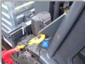
3. Die 4 Zurrketten an den 4 blau markierten Zurrpunkten des Staplers, respektive an den Zurrpunkten auf dem Flat, anbringen (FLAT: 2. Zurrpunkt vorne, 3. Zurrpunkt von hinten);
