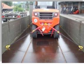
Mit dem Material, welches sich in jedem Transportbehälter 2563.5677 befindet, kann der Gasta Linde 2,5t 4x2 H30d auf dem Flat kraftschlüssig gesichert werden. Es wird kein weiteres Material zur Ladungssicherung benötigt.
