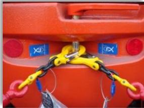
1. Zurrketten und Spanngurte auf äussere Beschädigung oder Verschleißerscheinungen prüfen;
