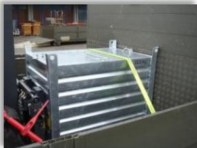
7. Der Verlad des Flats erfolgt durch einen ausgebildeten Motorfahrer. **Der Transport ist ausschliesslich mit dem Lastw WABRA/HA sch 10.6 t gl 6x6 Iveco und dem WABRA Verd 11.6 t durchzuführen (Höhe!).**
