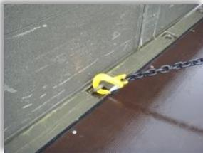
5. Transportbehälter mit Hilfe der Spanngurte niederzurren;
