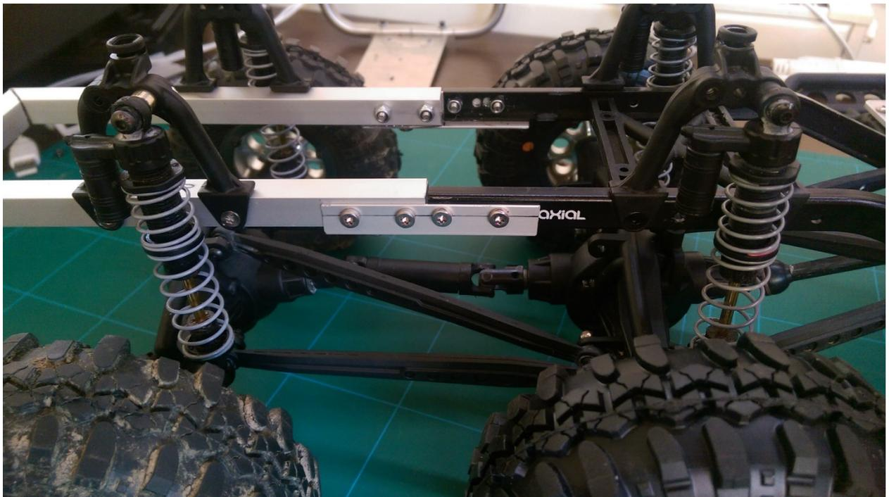
(7) Die Alu-Eck-Profile werden mit dem SCX10 Chassis und der Chassis-Verlängerung verschraubt. Ich verwendete dazu M3 Schrauben welche auf der Rückseite mit einer selbstsichernden Mutter gegengeschraubt werden.
