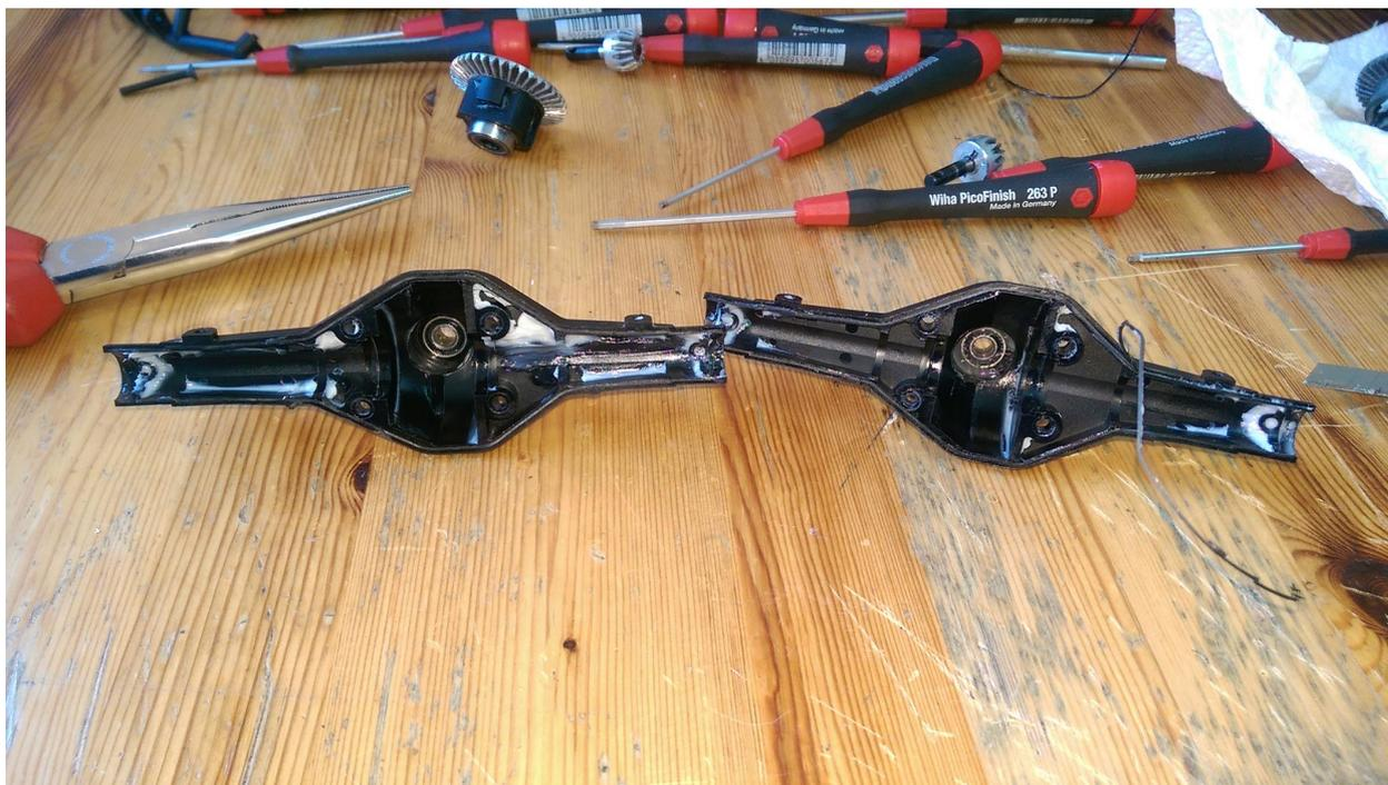
(1) Zuerst benötigen wir die zwei Axial Achsenteile welche die Ausgänge zur Kardanwelle haben.
