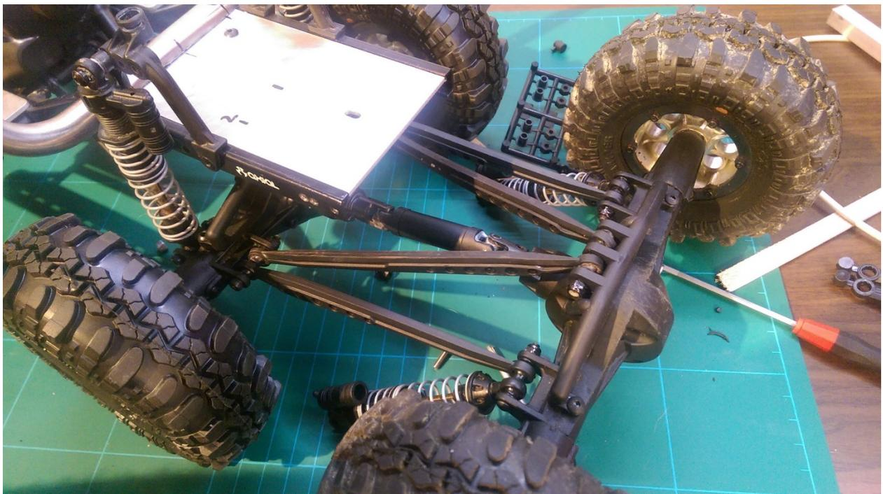
(4) Als nächstes wird die Durchlaufachse an die Position der derzeitigen Hinterachse montiert. Dann wird die Hinterachse mit den Links verbunden um die Kardanwelle einpassen zu können. Im gleichen Arbeitsschritt kann man auch die Stoßdämpfer montieren.
