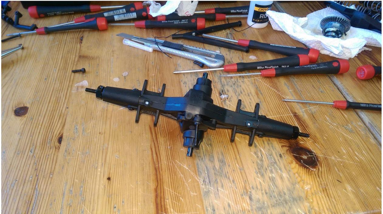
(3) Hier sieht ihr die bereits die zusammengefügte Achsenteile zu einer Durchlaufachse mit verbautem Differential welche jetzt den Durchlauf zu Hinterachse bildet.
