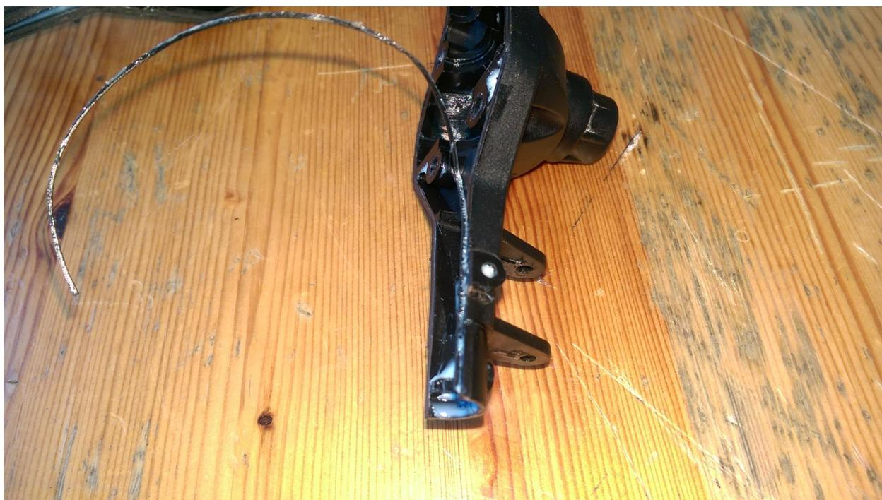
(2) Bei beiden Achsen Teilen wird der Flansch mit einem Cutter entfernt. Ist dieser Flansch entfernt passen die Achsen sauber aufeinander.
