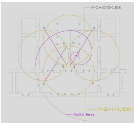
Fig. 32. Esta disposición de cuatro círculos llamados áureos, en un rectángulo de proporción  $P=\sqrt{5}-1=1,2361$ , tiene una característica singular en los puntos de encuentro entre círculos, ocho puntos en total llamados: A, B, C, D, E, F, G y H. De forma que los segmentos  $AG=CE=BH=FD$  definen en su rectángulo la proporción áurea, o sea,  $P=(1+\sqrt{5})/2=1,618$ .
