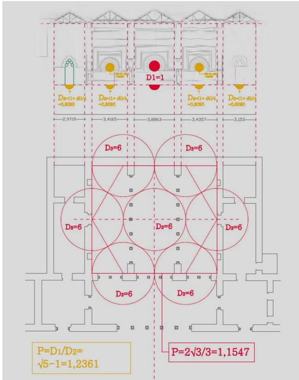
Fig. 27. Planta y alzado del testero principal norte del Salón Rico. Vemos la fijación del diámetro unidad en el diámetro del arco central que enmarca la posición principal del califa ( $D_1=1$ ). Los arcos laterales tienen un diámetro inferior [ $D_2=(1+\sqrt{5})/4=0,809$ ], lo que implica respecto del central la proporción  $P=\sqrt{5}-1=1,2361$ .
