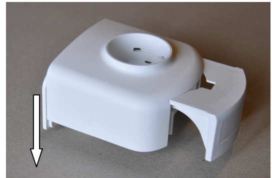
2. Wandhalterung entfernen (bei geöffnetem Schieber Wandhalterung nach unten drücken)
