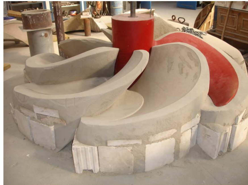
Unterform für 7-flügeligen Propeller
