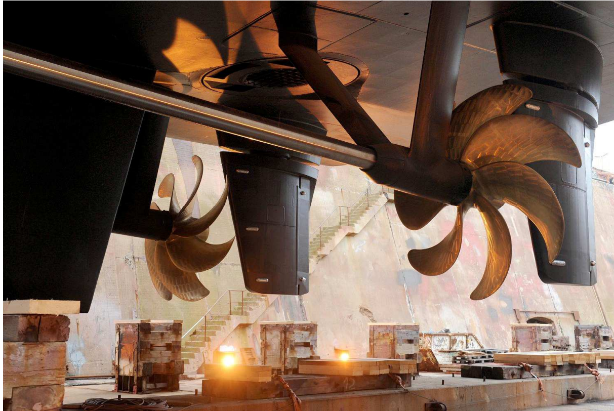
Wellenanlage mit V- und I- Böcken und 7-flügeligen Piening Propellern
