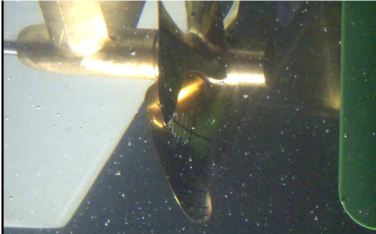
Karmansche Wirbelstrasse an der Hinterkante eines Propellerflügels.
