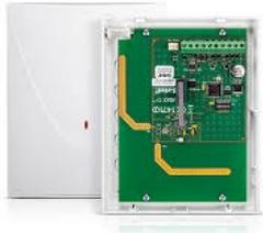
Das Funkbasismodul ACU-220 ist mit den Zentralen aus den Familien INTEGRA und VERSA kompatibel und ermöglicht die Erweiterung eines Alarmsystems um Funkkomponenten. Das Modul gewährleistet eine bidirektionale Kommunikation mit der Bestätigung aller Übertragungen.
