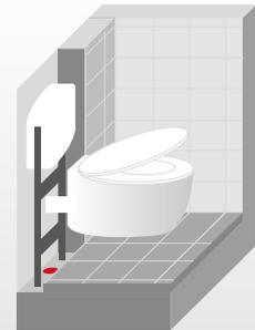
Die Punktsensoren werden im Zuge der Sanierung in die Bodenöffnungen (z.B. Trocknungsbohrungen) eingeführt und mit geeignetem Dämmmaterial aufgefüllt.
