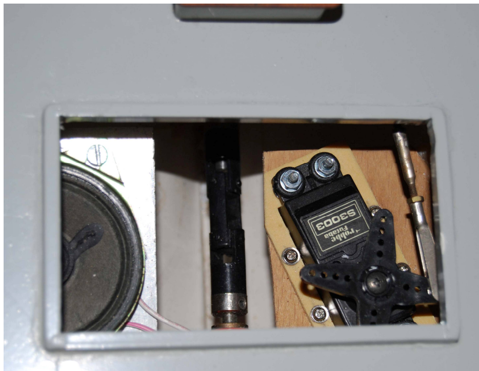
Bild 6: Ruderservo und Lautsprecher im hinteren Teil des Rumpfes
