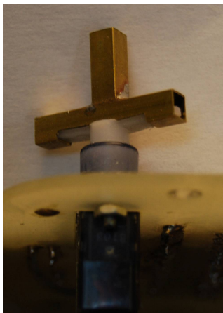
Bild 12 und 13: Vierkantantrieb auf dem Servo und am Feuerlöschmonitor.
