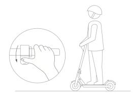
Sobald der Scooter leerläuft, stellen Sie beide Füße auf die Fußplatte, und betätigen Sie den Gashebel (der Gashebel greift, sobald die Leerlaufgeschwindigkeit 5 km/h überschreitet).
