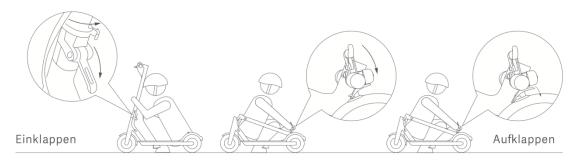
Stellen Sie sicher, dass der Scooter abgeschaltet ist. Entriegeln Sie zum Einklappen den Klappmechanismus, und stellen Sie den Lenkervorbau so, dass Sie die Schnalle auf dem hinteren Schutzblech einhaken können. Drücken Sie zum Aufklappen auf den Klingelauslöser, um die Schnalle zu lösen, stellen Sie den Lenker auf, und rasten Sie die Faltstruktur ein.
