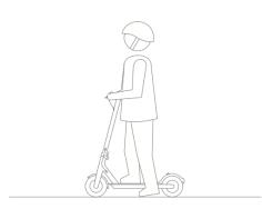
Steigen Sie mit einem Fuß auf die Fußplatte, und stoßen Sie sich mit dem anderen Fuß vorsichtig ab.
