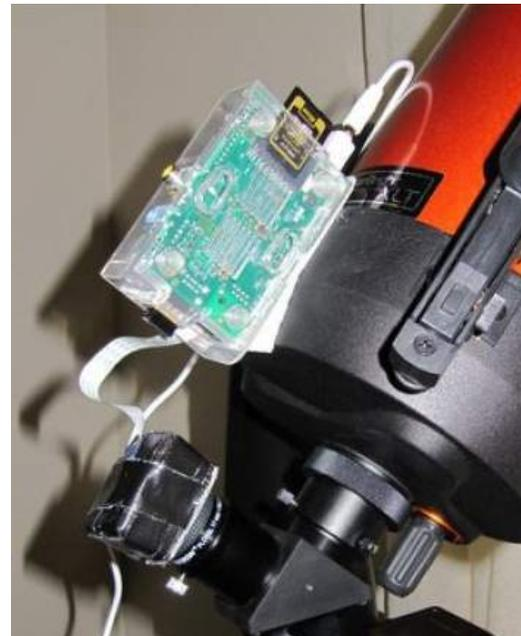
Bild: Ein Raspberry Pi Computer auf einem Fernrohr, der eine Webcam steuert. Das Linux Betriebssystem und die komplexe Software zur Nachführung passen auf eine SD Karte.
