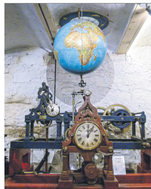
Das Uhrwerk ist mit einer Weltkugel verbunden und zeigt die Erdrotation.
