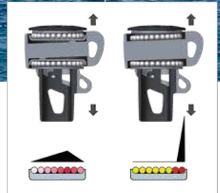
Der Lastverteiler schützt vor Punktbelastung einzelner Lagerkugeln!
