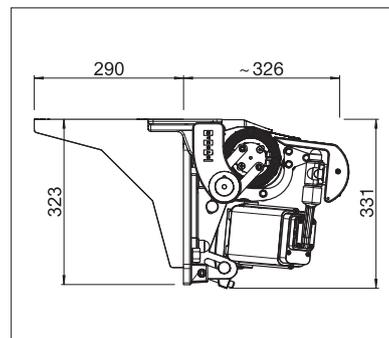
Deckenmontage mit Deckenwinkel
