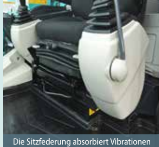
Die Sitzfederung absorbiert Vibrationen
