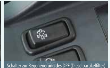
Schalter zur Regenerierung des DPF (Dieselpartikelfilter)
