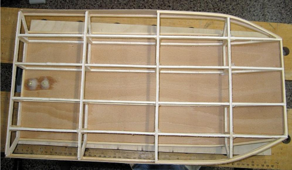
Im Anschluss wurden die Seiten, an denen danach die schrägen Seitenteile angeleimt werden, sauber verschliffen.
