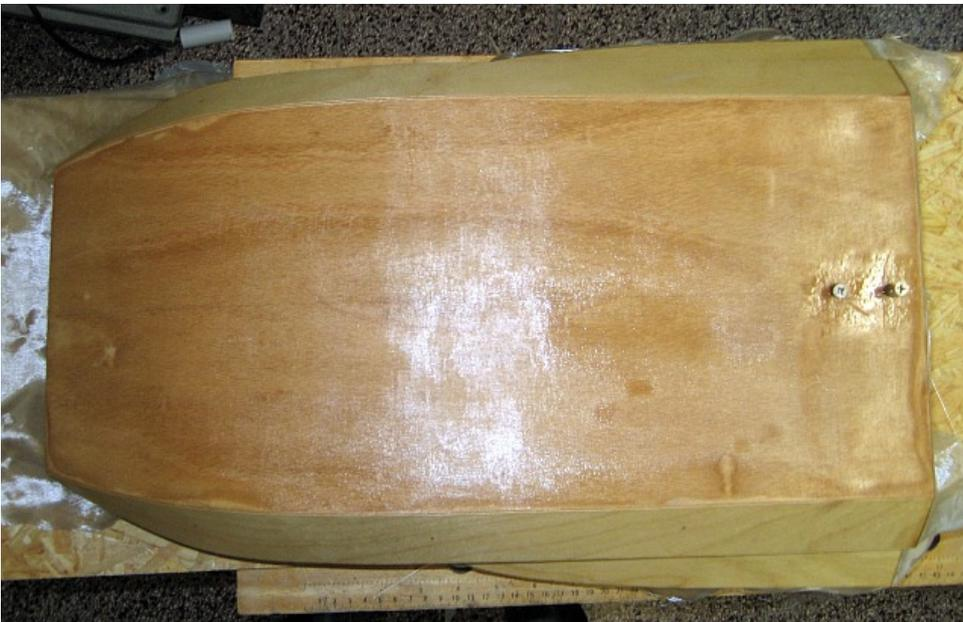
Als nächstes wurden die Seitenleitwerke gebaut. Diese bestehen aus drei Lagen 0,8 mm Sperrholz "kreuzverleimt", was sehr stabile und verwindungssteife Leitwerke ergibt. In der mittleren Lage befinden sich Ausschnitte, in die Kunststoffscharniere von den Fliegern eingeschoben werden können. Das ganze habe ich auch mit Epoxy eingepinselt.
