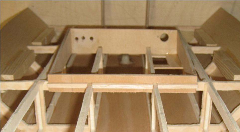
Das Deck wurde vorgebaut. Dazu habe ich 3 mm Balsabrettchen und 3 mm Sperrholz zusammengeklebt und entsprechend zurecht geschnitten, damit es einfach auf den Rumpf aufgeklebt werden kann. Für die stärker belasteten Stellen am Bug und am Motorträger wurde Sperrholz verwendet, für den Rest reicht Balsa.
