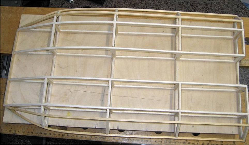
Der Boden wurde aus 1 mm Flugzeugsperrholz ausgeschnitten, und zwar ca. 2 mm größer als gezeichnet, das wird später beigeschliffen. Dieser wurde dann auf das Gerippe geleimt.
