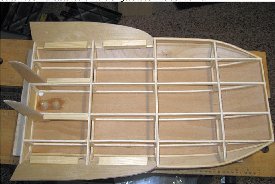
Servobrettchen wurde eingeleimt, ebenso der Rahmen für den späteren Deckel. Dieser enthält bereits die Bohrungen, durch die die Motorkabel und die Ruderanlenkung wasserdicht hindurch geführt werden.
