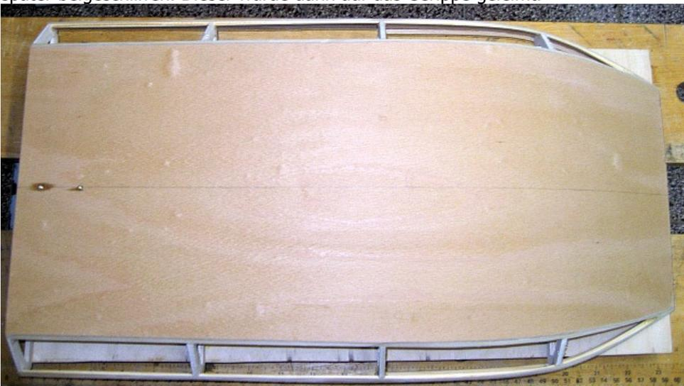
Das Boot wird mit einer abnehmbaren Finne ausgestattet. Dazu habe ich zwei Hutmuttern im Heckbereich mit andicktem Epoxy eingeklebt. Da kann später eine doppelte, aus einem kleinen Alu-U-Profil hergestellte Finne eingeschraubt werden. Anschließend wurden die oberen senkrechten Seitenteile ebenfalls leicht vergrößert aus 1 mm Sperrholz ausgeschnitten und aufgeleimt.
