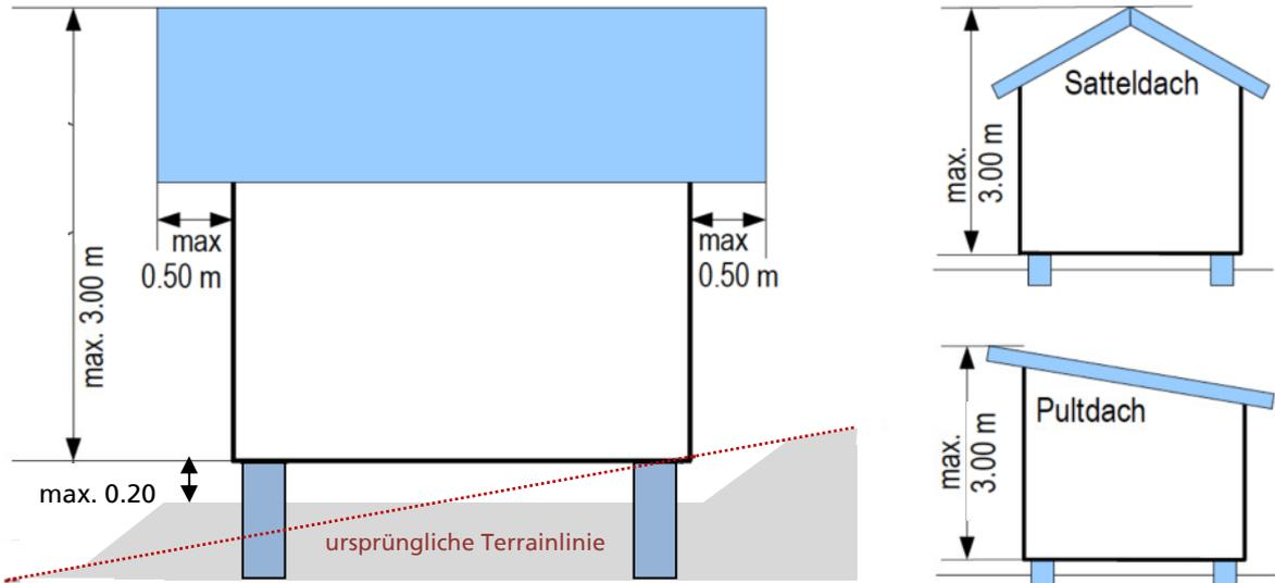
Die Firsthöhe wird ab Unterkante Bodenkonstruktion des Gartenhauses bis zum höchsten Punkt des Daches gemessen.
