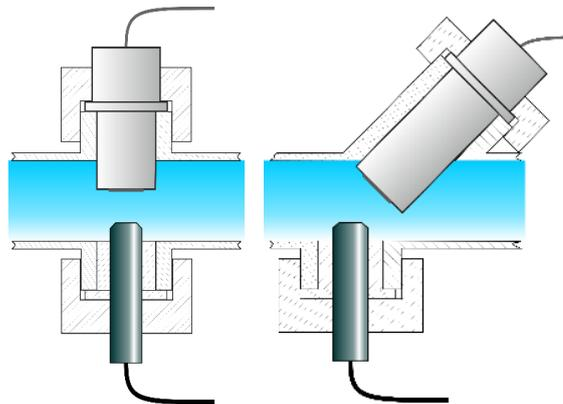
Der angewinkelte Einbau ist nur für Reinigungsanwendungen geeignet!
