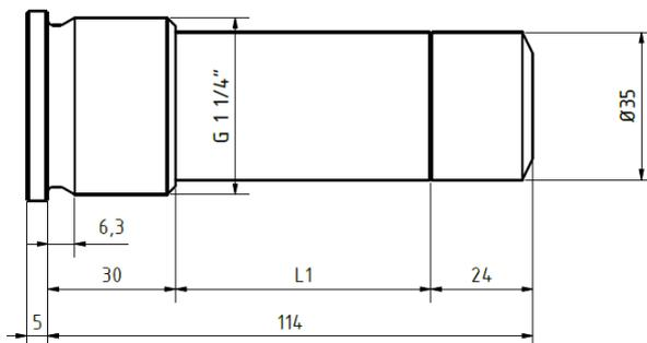
Rohrgewinde nach DIN ISO 228-1
