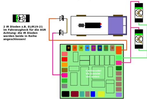
2 Fototransistoren in der Fahrzeugfront z.B. ELPT19-21B oder ELPT17-21B Diese werden parallel angeschlossen! Die Zuleitungen sollten so kurz und so dick wie möglich, separat und verdrillt ausgeführt werden.
