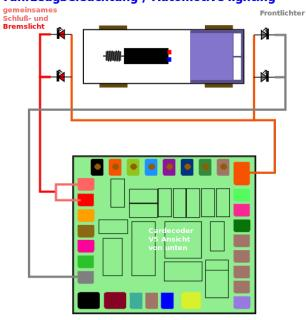
OpenCar-System Anschlussplan Cardecoder V5 Fahrzeugbeleuchtung / Automotive lighting
