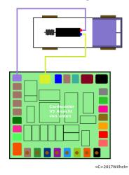
Der Motor wird am Cardecoder V5 lastgeregelt mit "high speed PWM" angesteuert.
