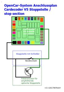
Der Stopp Eingang kann entweder durch einen Fototransistor (optisch) oder einen Reedkontakt (magnetisch) ausgelöst werden.
