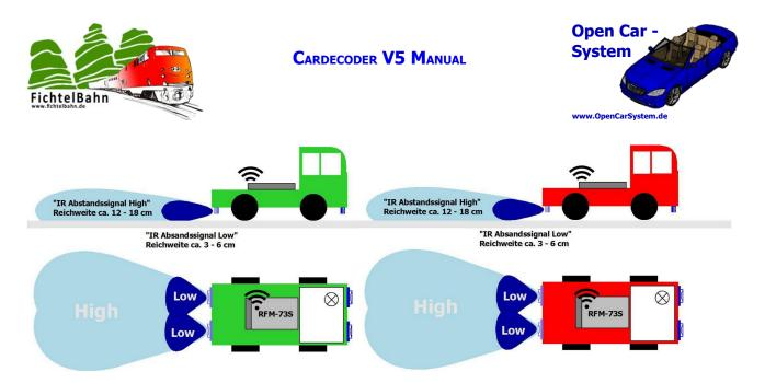
Die Abstandsregelung lässt sich mit der Funktion F3 abschalten. So kann man auch an einem stehenden Fahrzeug vorbeifahren. The distance control can be switched off with function F3. So you can also drive past a stationary vehicle.
