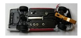
OpenCar-System hat die Faller© Ladebuchse durch einen weiteren Pin (im Abstand von zwei Pins) verdreh-sicher um einen Update-Anschluss erweitert (siehe Bild rechts). Über diesen The OpenCar-System has extended the Faller© charging socket with a further pin (two pins apart) with a secure update connection (see picture on the right). The firmware of the
