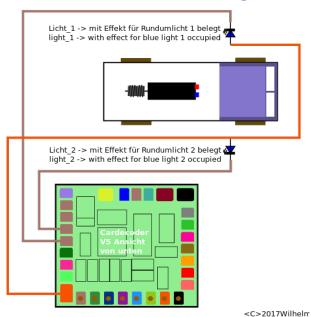
Es ist möglich, an einem LED-Ausgang vom Cardecoder parallel mehrere identische LEDs anzuschließen. Die Fahrzeugblinker sind dafür ein Beispiel (Bild links).
